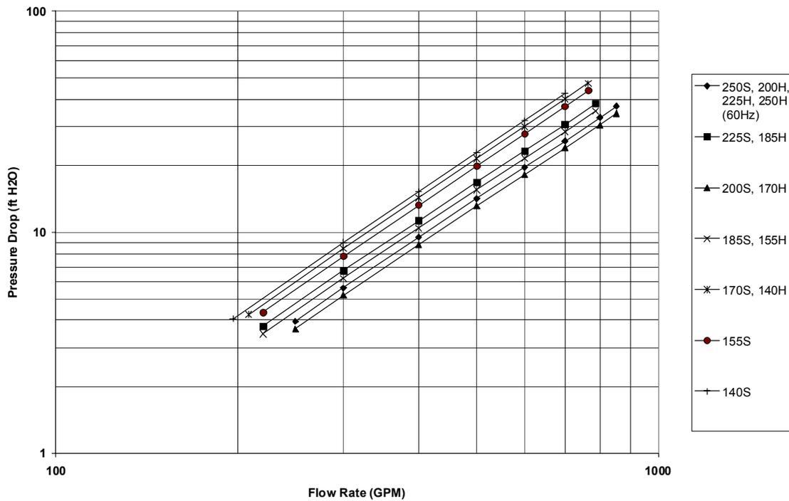
**Fig. 19 - Caída de la presión del agua en el evaporador, para 3 compresores**
